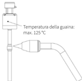
Temperatura superficiale del sensore in caso di malfunzionamento in relazione alla potenza di alimentazione.
