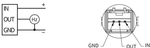
Connettore M12x1 senza uscita di temperatura
