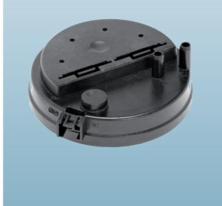
Il trasduttore di pressione modello 401 permette di misurare piccolissimi cambiamenti di  $\Delta P$  e sono progettati per fornire un ottimo controllo. Attraverso un dimensionamento ideale e grazie ad un'omogenea produzione dei due componenti della membrana, l'alta sensibilità e la riproducibilità delle misure sono garantite fino ad un campo inferiore a 20 pascal.
