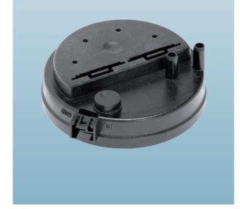
Les transmetteurs de pression de la série 401 permettent la mesure de très faibles variations d'air et trouvent leur application dans l'optimisation de circuits de régulation. Un dimensionnement idéal et une conception homogène de la membrane à 2 composants assurent une grande sensibilité et une excellente reproductibilité même pour des valeurs inférieures à 20 Pascal.
